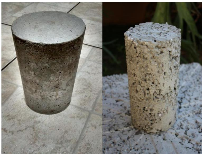
FIGURA 2 – Formato dos corpos de prova de tamanho padronizado pela ABNT, após o processo de cura e secagem
